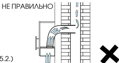
Якщо витяжка працює у режимі рециркуляції, вона не підключається до вентиляційної шахти. Повітря проходить через витяжку всередині кухні. При роботі витяжки у такому режимі на неї повинні бути встановлені одноразові вугільні фільтри (Можна придбати окремо).
